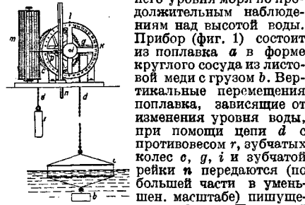
Фиг. 1. Водонерный указатель для определения среднего уровня моря по продолжительным наблюдениям над высотой воды. Прибор (фиг. 1) состоит из поплавка a в форме круглого сосуда из листового меди с грузом b . Вертикальные перемещения поплавка, зависящие от изменения уровня воды, при помощи цепи d с противовесом g , зубчатых колес e , g , i и зубчатой рейки h передаются (по большей части в уменьшенном масштабе) пишущему штифту p . Последний отмечает ход вертикальных перемещений поплавка на барабане m , вращающемся при помощи часового механизма. Для непосредственного отсчета колебаний уровня на оси зубчаток g и i помещено колесо k большого диаметра, разделенное по окруж-
