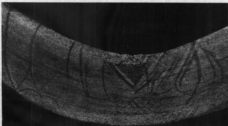
4. Линии деформации в днище котла, проявленные методом Фри (Fry).
